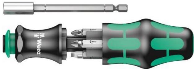
Outil compact Wera avec manche Kraftform multicomposants pour des vitesses de travail élevées et un vissage particulièrement ergonomique. Réserve d'embouts intégrée au manche, permettant de loger 6 embouts. En situation de vissage confinée, la lame baïonnette peut être rentrée. Elle peut également être retirée pour permettre un usage mécanisé. Le jonc d'arrêt et le puissant aimant permanent garantissent le solide positionnement des embouts.
