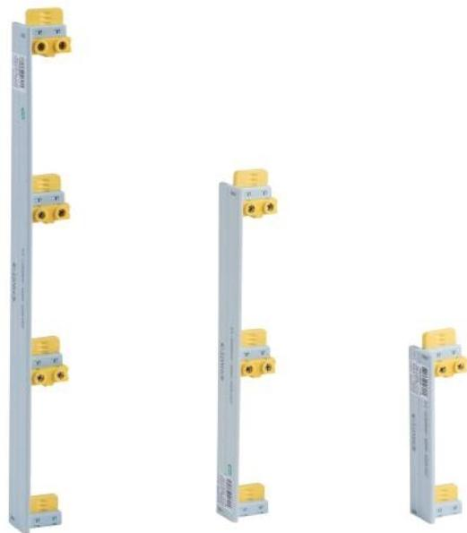
Peignes verticaux pour l'alimentation des interrupteurs différentiels par le bas, et offrant une ou plusieurs bornes de repiquage L et N. Cache borne et borne d'alimentation et repiquage jusqu'à 16 mm<sup>2</sup>.
