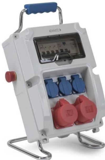
Coffret de chantier comprenant un dispositif d'arrêt d'urgence intégré et un support avec dispositif d'enroulement du câble. IP65. Puissance maximal : 3 500W en monophasé et 6000W en triphasé. 3 prises 2P+T 16A à clapet, 2 prises 3P+N+T 16 A à clapet, 1 interrupteur différentiel tétrapolaire 40A type AC 30 mA, 1 disjoncteur tétrapolaire 16A, 1 disjoncteur monophasé 16A, passe fil à gradin sectionnable. Livré sans câble d'alimentation.
