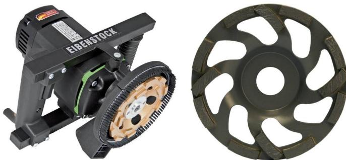
Machines idéales pour lisser les imperfections, enlever les vieilles peintures et les restes de colles, égaliser les surfaces etc. Ponçage à sec. Avant du carter amovible pour le ponçage au ras des murs. Conception verticale du moteur = durée de vie prolongée. Démarrage progressif. Système anti-vibration. Raccordement direct à l'aspirateur pour une meilleure évacuation des poussières. Poignées placées en parallèle pour + de confort et de stabilité.
