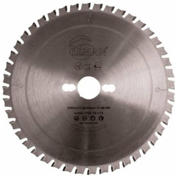
Convient pour couper cornières, tubes métalliques, tôles, tubes carrés, fers plats, fers ronds, profilés métalliques, panneaux sandwich. Coupe rapide à sec propre, sans étincelle, sans échauffement. Vitesse de rotation maximum 1200tr/minute.
