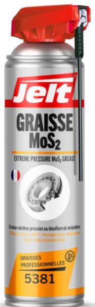
Extrême pression : réduit le coefficient de frottement. Utilisation : les articulations, les chaînes, les câbles, les paliers lisses, les rotules, les roulements à billes, les rouleaux travaillant à vitesse moyenne sous forte charge. Propriétés exceptionnelles anti-usure. Excellente stabilité mécanique. Propriété anti-grippante. Résiste à l'eau. Antioxydante. Utilisable entre -20°C et +180°C.
