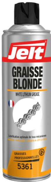
Graisse ambrée multifonctions de grade NLGI 2, formulée à partir d'un savon de lithium et d'une huile minérale. Utilisation : articulations, axes, roulements, galets, paliers... Très bonne stabilité mécanique. Protège protection contre la corrosion. Charges modérées. Ne se décompose pas. Ne coule pas. Bonne stabilité. Résistance aux vibrations. Utilisable entre -20°C et +150°C.
