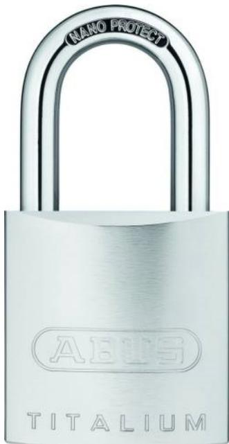
Boîtier en laiton massif. Corps de cadenas chromé pour une meilleure protection contre la corrosion. Double verrouillage à bille. Cylindre ABUS-Plus à disques: très grand nombre de clés différentes. Très haute protection contre toutes sortes de manipulations. Anse en acier spécial, cémenté. Le cylindre peut-être modifié et adapté aux fermetures existantes. Clé prisonnière : verrouillage uniquement avec la clé (la clé ne peut pas être retirée quand le cadenas est ouvert). Vendu avec 2 clés.
