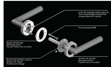
Rosaces angulaires et brevetées à trois pièces avec ergots de fixation 7 mm et bague coulissante en nylon. Fixation définitive par vissage de la bague de finition, plus ressort de rappel. Vis traversantes M4. Fixation invisible. Carré 7 mm avec perçage décentré. Epaisseur de porte standard: 37 - 43mm. Diamètre de poignée: 22mm.
