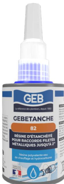
Résine d'étanchéité anaérobie au PTFE assurant l'étanchéité des raccords filetés métalliques coniques ou cylindriques. Etanchéité des circuits de chauffage central (eau froide, eau chaude, eau glycolée, eau additivée). Etanchéité des hydrocarbures de chauffage (fuel, mazout,...). Etanchéité des circuits d'air comprimé, de vapeur d'eau. Non démontable.
