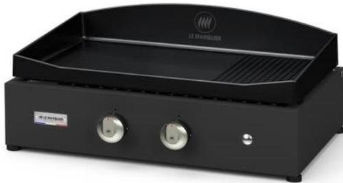
Plaque fonte émaillée inclinable (avec trou). Brûleurs inox trompettes. Allumage piezzo électronique. Boutons de commande ergonomiques et antidérapants. 4 pieds réglables en hauteur. Récupérateur inox circulaire Ø9cm inclus. Châssis en version acier peinture époxy coloris noir. 2 brûleurs inox, butane ou propane. Norme CE. Certification Origine France Garantie. Garanties : à vie pour la plaque et les brûleurs, 2 ans pour le châssis et 5 ans pour le piezzo.
