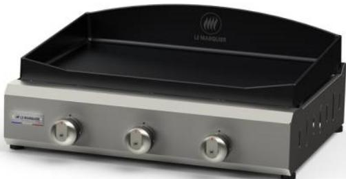
Plaque fonte émaillée inclinable (avec trou). Brûleurs inox droits double paroi à haut rendement. Sécurité thermocouple. Allumage piezzo électronique. Boutons de commande ergonomiques et antidérapants. 4 pieds réglables en hauteur. Récupérateurinox carré 9x9cm inclus. Châssis en versioninox mat+. 3 brûleurs inox, butane ou propane. Norme CE. Certification Origine France Garantie. Garanties : à vie pour la plaque et les brûleurs, 10 ans pour le châssis et 5 ans pour le piezzo.
