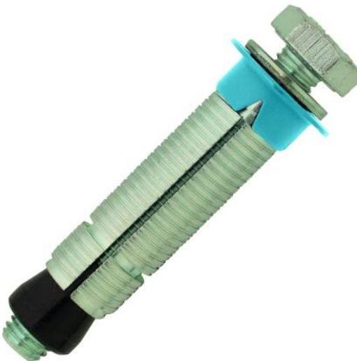
La cheville multi-matériaux charges lourdes est en acier zingué. Excellente tenue dans tous types de matériaux supports pleins ou creux grâce à son système d'expansion en 2 parties. Reprise de charges élevée, même dans les maçonneries creuses.
