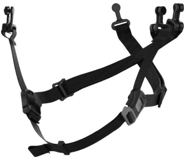
Jugulaire 4 points d'attache pour les casques EVOLite®, EVO®2, EVO®3, EVO®5, EVO® Full Brim & EVO®VISTA®. Conçu pour se rompre lorsque soumis à une force entre 150N et 250N. Sangle en nylon tissé de 14mm et boucles en nylon.
