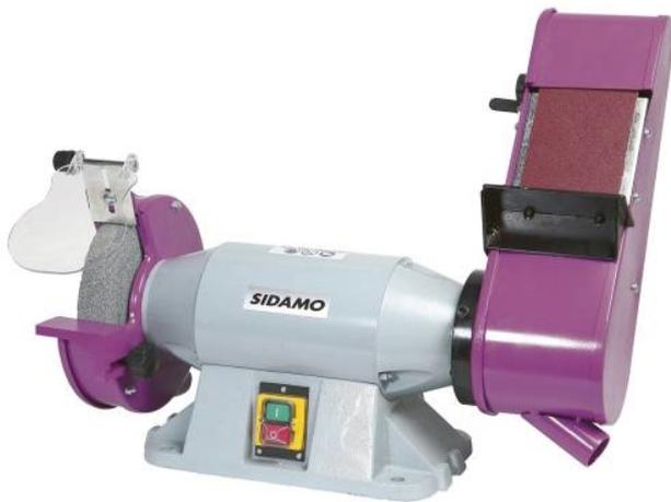
Meulage à sec et ponçage à bande de métaux ferreux. Usage régulier. Corps en fonte d'acier. Montage sur roulements à billes étanche auto-lubrifiés. Interrupteur à bobine à manque de tension. Écran de protection en polycarbonate. Protection thermique automatique interne au moteur. Carters en acier embouti équipés d'une buse de captage des poussières. Pare-étincelles et porte-outils réglables à 2 mm de la meule. Carter de bande orientable de 0° à 90° pour travail horizontal ou vertical.
