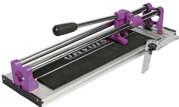
Découpe manuelle à sec de carrelage à usage d'appoint. Découpe avec grande précision. Carreaux d'épaisseur standard jusqu'à 12mm. Guide de coupe sur douilles à billes pour une utilisation douce et précise. Butée latérale avec réglage angulaire pour coupes droites et diagonales. Base en aluminium extrudé assurant rigidité et légèreté. Molette au carbure revêtue titane diamètre 22mm. Séparateur mobile.
