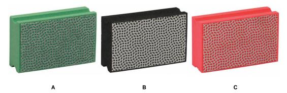
Pour ponçage et polissage à sec ou à eau les bords coupés des carreaux de céramique et de pierres naturelles. Bloc en caoutchouc EVA avec forme évidée pour une prise en main optimale. Haute qualité avec plaque support en métal. La rigidité du support permet plus de précision, de durabilité et d'efficacité de travail. Face diamantée en maille torsadée. Les diamants de haute qualité utilisés assurent une longue durée de vie et une performance constante. Dimensions : 94x58x30mm
