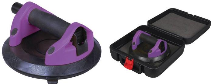
Ventouse à pompe utilisant le vide pour soulever, tenir et placer des matériaux lisses et non poreux tels que: le carrelage, les dalles sur plot, le marbre, les plaques de granit, le verre et les surfaces rugueuses. Adhésion rapide sur les surfaces lisses ou rugueuses et non poreuses. Témoin rouge d'indication de perte d'adhésion. Levier de décompression pour retirer rapidement la ventouse. Poignée Bi-matière résistante. Pompe ABS. Livrée dans sa mallette de transport.
