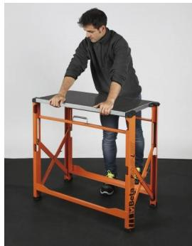
Léger, facile à transporter. Plan de travail de 800x500 mm en tôle galvanisée utilisable d'un seul côté, protégé par un revêtement en caoutchouc de protection contre l'huile et l'essence. Poignée avec protection en caoutchouc pour un transport aisément. Un plan de travail supplémentaire, solide et fiable, toujours à portée de main. Poids : 18,5 kg. Capacité de charge statique : 200kg.
