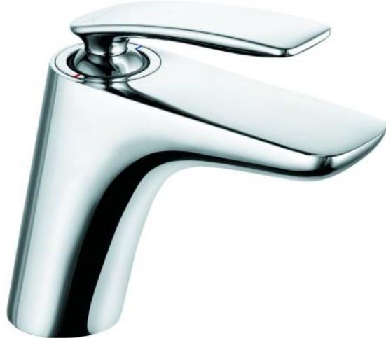
Mitigeur de lavabo DN 10. Levier plein. Montage monotrou. Débit classe Z. Régulateur de jet caché éco s-pointer M24x1. Cartouche céramique avec limiteur eau chaude. Sans garniture de vidage. Système de montage rapide. Raccords flexibles G 3/8. Classe acoustique I. Limiteur de débit 8L/min.
