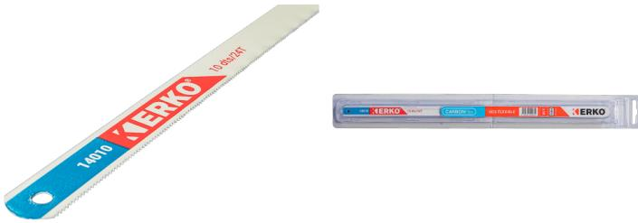
Lame HCS flexible pour usage courant. Technologie acier à haute teneur en Carbone HCS. Le traitement thermique de l'acier lui confère une grande souplesse. Pour les aciers doux, les non-ferreux et les aciers faiblement alliés.
