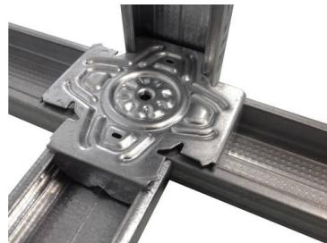
Cela permet de connecter jusqu'à 3 fourrures. C'est une solution résistante pour renforcer l'ossature ou incorporer un élément dans cette dernière (trappe, porte, fenêtre). C'est destinée à la réalisation de structure porteuse servant de support à la plaque de plâtre. Elle peut être utilisée dans les pièces humides. Elle permet de solidariser, assembler ou relier rapidement et de manière sûre deux ou trois fourrures.
