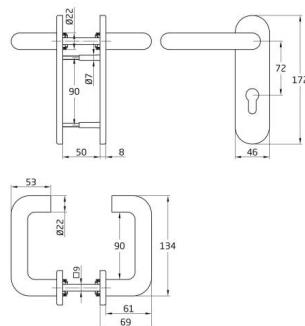
Poignée avec âme en acier et revêtement en polypropylène noir mat, ce qui lui confère rigidité et dureté, absence de charge électrostatique, haute résistance aux solvants et stabilité par rapport aux différences de température. Avec trous de serrure de 72 mm. Fixation par boulons traversants antivol.
