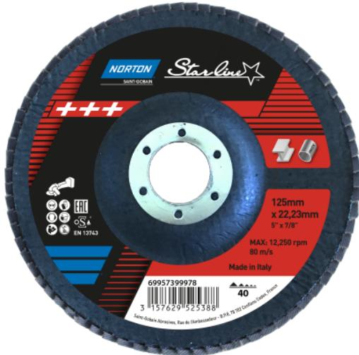
Disque polyvalent grain d'oxyde de zirconium pour le travail sur l'acier, sur les alliages, ou les matériaux souples comme le bois. Bon enlèvement de matière en dégrossissage et ébavurage.
