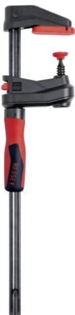
Poignée en matière synthétique bi-composant de qualité positionnée autour du rail pour une utilisation du serre-joint dans les espaces les plus exigus. Force de serrage de jusqu'à 2 000N. Tige filetée trapézoïdale facilement manœuvrable avec plaque de pression pivotante. Bouton de déplacement rapide pour le réglage rapide de l'étrier coulissant.
