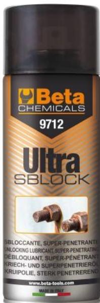
Débloquant et désoxydant, fort pouvoir pénétrant pour éliminer rapidement la rouille et l'oxydation présentes sur les écrous, les boulons, les vis et les engrenages. Hydrofuge pour éliminer l'eau et l'humidité des parties traitées. Forte résistance thermique (de -40 °C à +150 °C). Appliquer le produit et attendre pendant quelques minutes.
