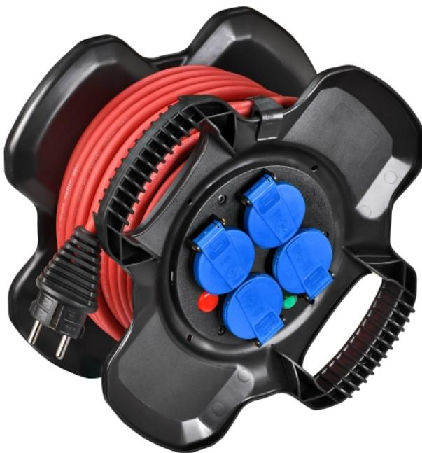
Pour utilisation à l'extérieur. 4 prises de courant 2P+T 16A/230V~ . 1 fiche 2P+T 16A/230V~. Puissance maxi : câble non déroulé 1000W - câble déroulé 3500W. Léger, compact et robuste avec 2 poignées intégrées. La structure du support est composée d'un matériau en plastique/caoutchouc pour résister aux charges lourdes. Câble H07RN-F résistant aux hydrocarbures et adapté aux conditions extrêmes sur les chantiers. Avec disjoncteur thermique. Protection IP44
