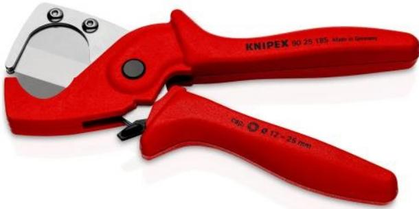
Coupe nette : coupe les tubes multicouches aluminium et plastiques avec une grande précision. Pour couper des tubes multicouches de Ø 12 - 25 mm. Surfaces de coupe propres, lisses et sans bavures. Lames faciles à changer. Avec ressort d'ouverture et système de verrouillage. Poignées ergonomiques en plastique renforcé de fibre de verre. Ne convient pas pour couper des câbles. Lame en acier spécial haute résistance, trempé à l'huile et traité.
