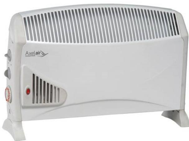
Capot en acier peint couleur blanc. Alimentation 230 VAC. Câble d'alimentation électrique longueur 1,5 m. 3 puissances : 800 - 1 200 - 2 000 W. Résistance électrique sur feuille mica avec protection thermostatique. Sécurité anti-renversement l'alimentation se coupe si l'appareil est penché. Témoin lumineux de fonctionnement. Thermostat d'ambiance mécanique. Protection IP20. Classe d'isolation I. Ventilateur centrifuge en nylon renforcé ignifugé.
