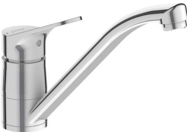
Mitigeur évier, bec profilé orientable avec cartouche C3 à économie d'eau et d'énergie (levier centré = eau froide). Système d'installation facile et rapide 5/35". Avec flexibles d'alimentation. Bague-limiteur de température. Economiseur d'eau : butée sensitive. Aérateur anti-calcaire. Percement : 35 mm. Débit : 10 l/mn.
