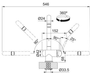
Mitigeur Window à bec rabattable spécial fenêtre (hauteur sous fenêtre minimum de 80mm). Type de cartouche céramique simple. Raccordement : Flexibles inox F12x17. Rotation du bec : 360°. Hauteur 298mm. Embase 50mm. Perçage 35mm.
