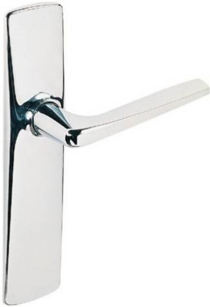
Ensemble monobloc : béquille et plaque solidarisées. Plaque fondue avec piliers taraudés intégrés et vis invisibles côté extérieur. Entraxe 165mm.
