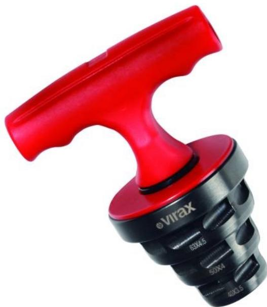
Deux fonctions incontournables pour sertir le tube multicouche : recalibrer le tube après l'opération de coupe et ébavurer l'intérieur du tube pour éviter de blesser le joint torique du raccord. Produit résistant, corps en acier bruni, dureté 95 HrB. Poignée plastique pratique. Facilité d'utilisation et rapidité grâce à son cliquet intégré.
