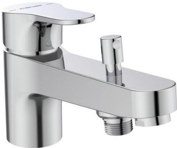
Mitigeur bain-douche monotrou Olyos chromé. Bec long avec aérateur intégré. Inverseur à retour automatique tout métal. Sortie de douche 1/2 par le dessous avec clapets anti-retour intégrés. Cartouche Firmaflow® Ø 38 mm à 2 disques céramique, avec limiteur de température intégré et limiteur de débit 50 % déverrouillable. Flexibles anti-torsion PEX 3/8" - 350 mm. Montage sur gorge. Click technology. SmartShine.
