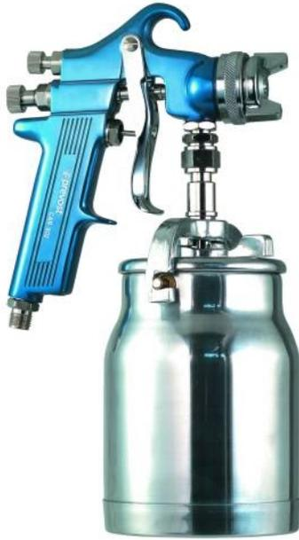
Pistolet de peinture par aspiration pour travaux industriels ou automobile. 3 types de réglage (largeur du jet, débit de peinture et débit d'air). Corps en aluminium anodisé bleu. Godet 1 litre en aluminium. Godet à fermeture rapide par étrier, anti-goutte. Pression de service : 3,5 bar à 5 bar. Raccordement: G 1/4 M. Raccordement au godet : G 3/8 M. Ø buse 1,6mm.
