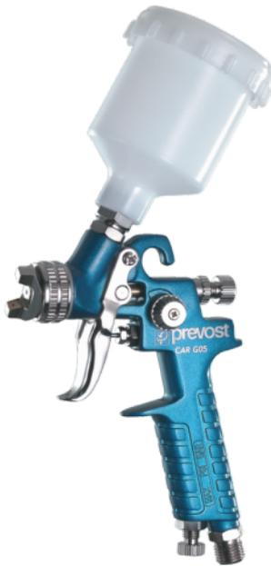
Pistolet de peinture pour retouche carrosserie vernissage travaux de décoration (automobile et industrie). 3 types de réglage (largeur du jet, débit de peinture et débit d'air). Corps en aluminium anodisé bleu. Godet 0,125 litre en polyamide. Pression de service : 2,6 bar à 4 bar. Raccordement : G 1/4 M. Raccordement au godet : M14 x 1,0P. Ø buse 8mm.
