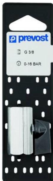
Mini-vanne papillon femelle/femelle cylindrique PN 16. Passage réduit. Température d'utilisation : -10°C à +90°C. Matière : laiton chromé.
