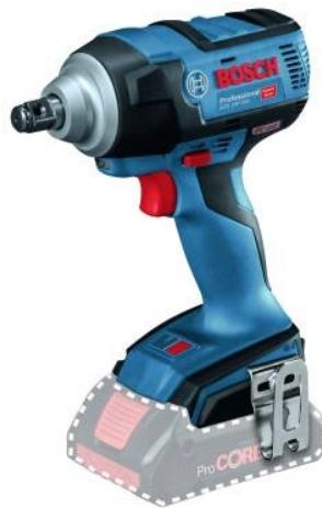
Boulonneuse sans charbon avec un couple de serrage élevé de 300 Nm. Forte puissance et grande flexibilité pour des résultats parfaits : grâce au couple de serrage élevé (jusqu'à 300 Nm), au design compact et léger et à l'absence de fil. Le moteur sans charbon garantit une puissance élevée, une grande autonomie et une longue durée de vie de l'outil. La fonction Auto Bolt Release (ABR) arrête automatiquement l'outil en mode dévissage pour que l'écrou ne tombe pas une fois desserré.
