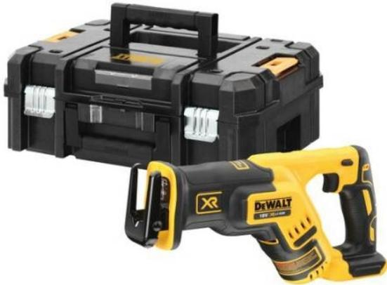
La scie sabre DCS367NT XR 18V Brushless de Dewalt, au format compact, permet un meilleur accès pour des coupes avec accès restreints. Changement de lame sans clé. Emmanchement de lame 4 positions pour une découpe au ras et plus de polyvalence. Centre de gravité près de la poignée pour une meilleure prise en main. Lampe LED intégrée pour une meilleure visibilité de la coupe.
