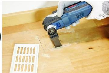
Lame Starlock pour les coupes nettes dans le bois dur et résineux. Denture japonaise tridimensionnelle réduisant le développement de la chaleur pour des coupes sans éclats. Design plat réduisant le vacillement et favorisant la précision, grâce à un transfert de puissance optimal et direct. Support Starlock pour un transfert de puissance maximal et un changement de lame facile en 3 secondes.
