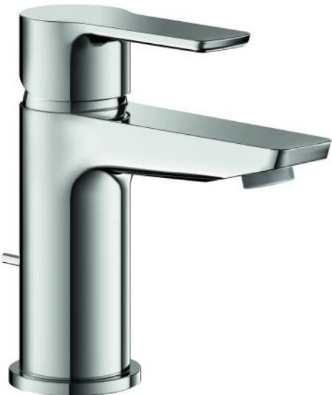
Mitigeur lavabo avec un vidage en laiton. Cartouche C3. Hauteur 138mm. Saillie 101mm. Hauteur sous bec 88mm. Garantie 8 ans.
