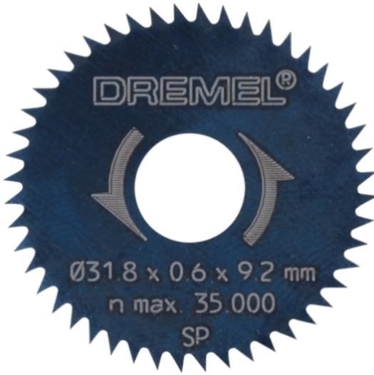
Lame de scie précise pour les découpes fines, nettes et droites dans toutes sortes de bois. Idéale pour les stratifiés, les parquet en bois ou les panneaux de bois minces. Entièrement en acier au carbone avec 48 dents inclinées garantissent une découpe rapide et précise jusqu'à 6,35 mm. À utiliser uniquement avec l'adaptation mini-scie Dremel 670. La lame en acier de 31,8 mm de diamètre se monte directement sur l'adaptation mini-scie 670 sans avoir à utiliser de mandrin.
