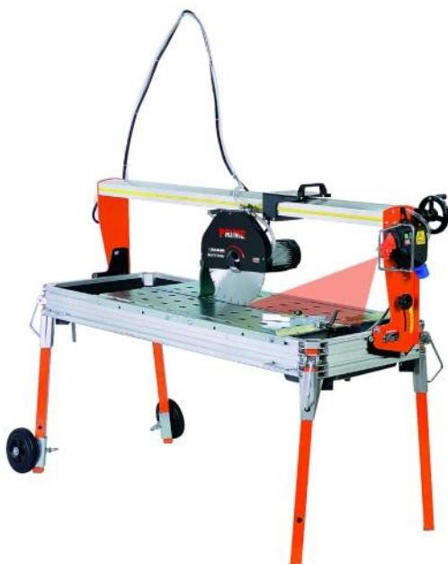
Idéale pour la coupe de carreaux format XXL. Coupes précises et rapides, droites ou à 45°, de grès cérame 20 mm, 10 mm, carrelage et faïence. Laser de guidage. Rail de guidage équipé d'une voie en acier inox interchangeable. Tête de coupe montée sur 8 roulements = précision de coupe absolue. Réglette de longueur de coupe pour des travaux en série rapide. Profondeur de coupe réglable. Equerre réglable. Avance semi-automatique par manivelle. Châssis en aluminium léger et robuste.
