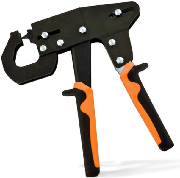
Pour sertir tous types de rails et montants, lisses et fourrures F530. Utilisation à 1 main sans effort grâce à son système de crémaillère (3 crans pour que le poinçon arrive en contact sur le rail et 1 cran et demi pour sertir). Capacité max. : 1+1mm. Poinçon breveté permettant une amélioration du sertissage de 60% et une réduction d'effort de 30%.
