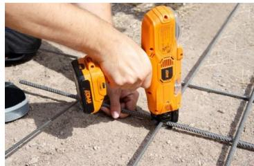
Léger et compact. Permet de lier les fers à béton rapidement, de manière efficace et sans effort. Puissance de serrage réglable selon les dimensions de fer à lier. Utilisation de bobines de fil de 100m, soit environ 280 liens/bobine. Capacités de liage : ø 12 à 24mm.
