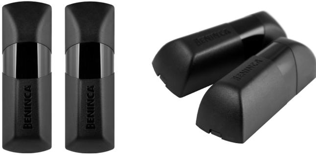
Jeu de photocellules pour montage extérieur. Dimensions réduites 110 x 36 x 31 mm. Equipées de led signalant l'alignement optimal du faisceau.
