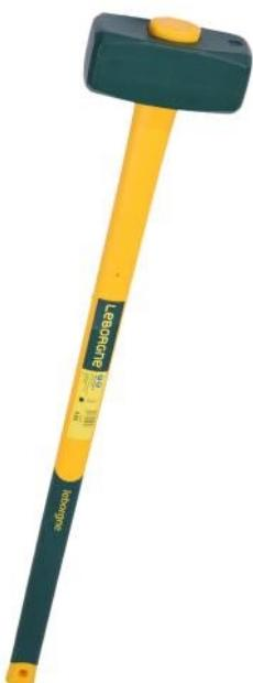
Pour frapper, démolir, enfoncer des coins... Tête en acier au carbone forgé, trempé et revenu : résistance à l'usure. Angles arrondis : retardent le refoulement matière, diminue les risques d'éclats. Faces latérales plates : réduit les risques d'éclater les piquets en bois. Emmanchement douille rase : protège l'extrémité du manche.
