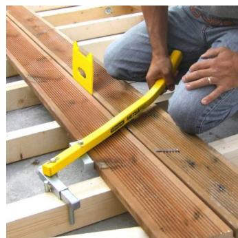
Pour dégauchir les grandes lames de terrasse en bois lors de la pose. Manche ergonomique. Poignée élastomère : confort de la prise en main. Mâchoires et cale interchangeables, permet d'adapter l'outil au sens de montage du plancher (fonctionne aussi bien en tirant qu'en poussant). Couleur jaune vif, facilement visible sur le chantier. Réglage micrométrique (de 50 à 100mm) de la mâchoire par vis (plus précis que par crans) suivant la largeur des lambourdes. Hauteur des ergots = 50mm.
