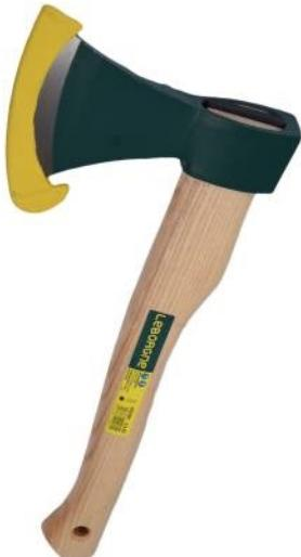
Pour tous petits travaux de jardin : couper du petit bois, planter les clous, des piquets, installer une clôture. Acier forgé et trempé pour une meilleure résistance à l'usure . Couplant prêt à l'emploi, géométrie du taillant et polissage : qualité de coupe et résistance à l'usure. Manche galbé ergonomique : confort de la prise en main. Emmanchement douille rase par coin. Avec manche bois certifié PEFC 100% ou FSC 100%.
