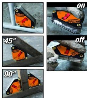
Idéal pour positionner vos pièces avant de souder. 25kg de force magnétique. Sans pile, effet marche/arrêt obtenu avec l'inclinaison des aimants internes. L'interrupteur sur arrêt permet de démagnétiser l'aimant et de se débarrasser de limailles de fer.
